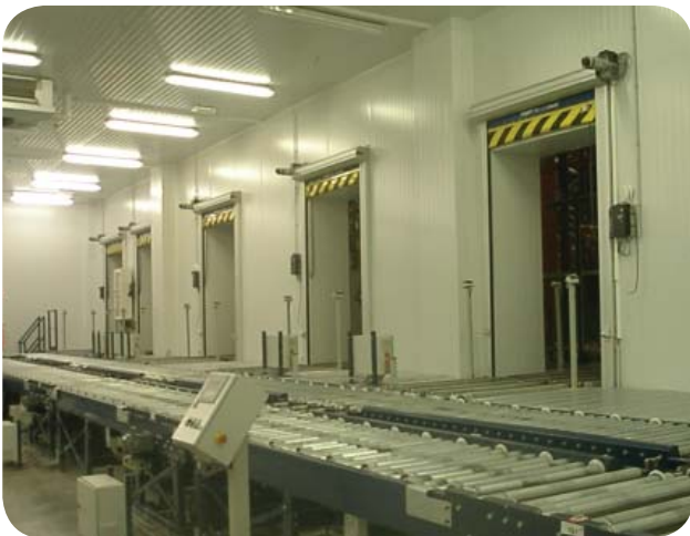
Rapid Rolling Doors in combination with an automated pallet transport system Fish processing and storage installation (Zaragoza, Spain) Porte rapide enroulable combiné avec un système automatisé de transport de palettes. Installation de traitement et de stockage du poisson (Saragossa, Espagne) Schnellaufrolltor in Kombination mit einem System zum automatischen Transport der Paletten Anlage zur Fischverarbeitung und -lagerung (Saragossa, Spanien)
